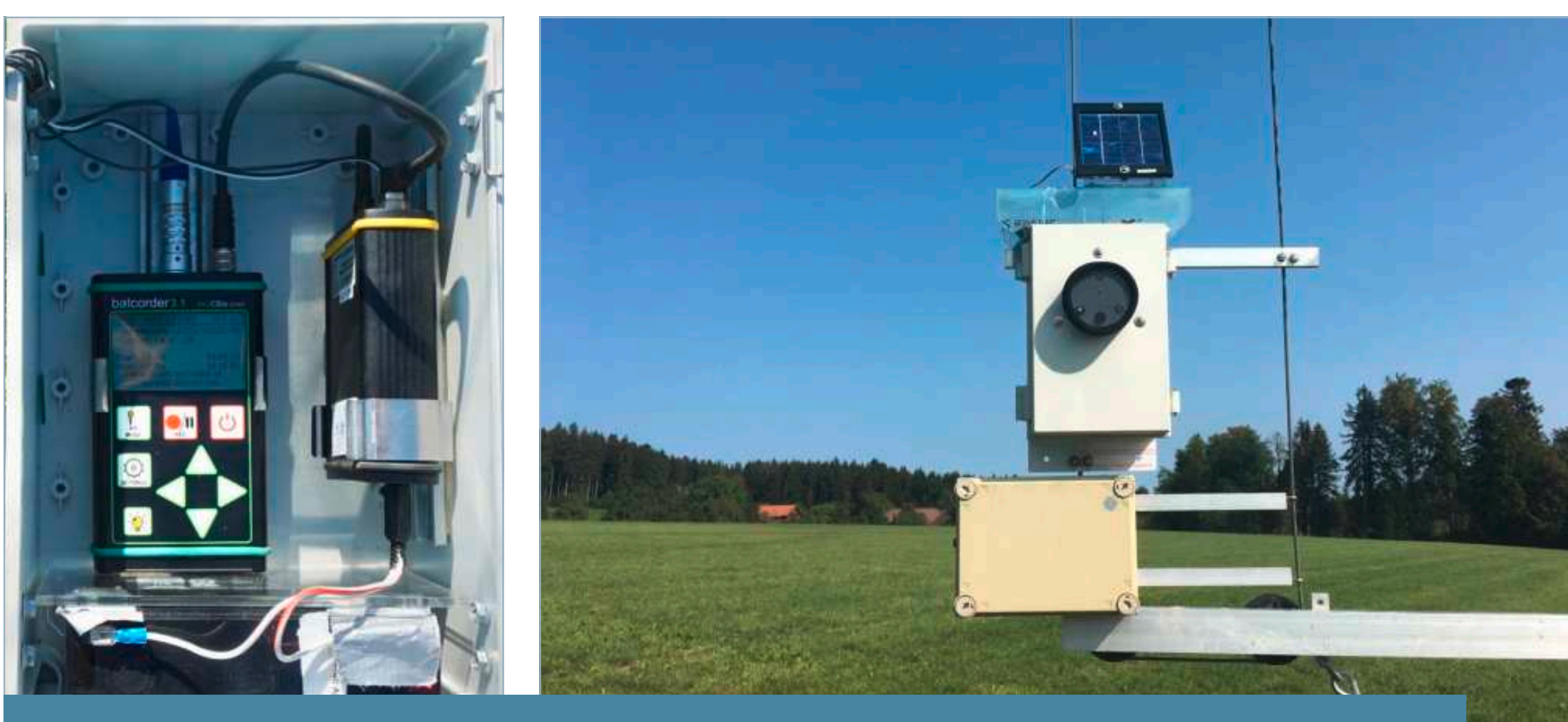
Abb. 1a) Position des Messgerätes auf 88 m. 1b) BatUnit mit Batlogger. 1c) BatUnit von aussen. Das Mikrofon ist die schwarze Scheibe. Quelle: SWILD.
