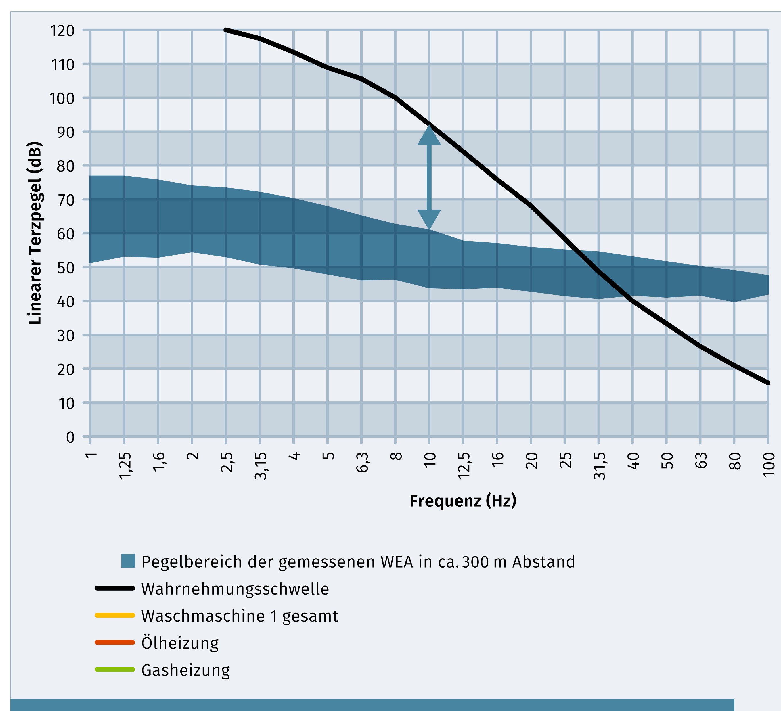
Abb. 1: Die gemessenen Werte von Infraschall von Windenergieanlagen zeigen, dass der von Windenergieanlagen erzeugte Infraschall in 300 m Entfernung deutlich unterhalb der Wahrnehmungsschwelle lag. Quelle: LUBW.
