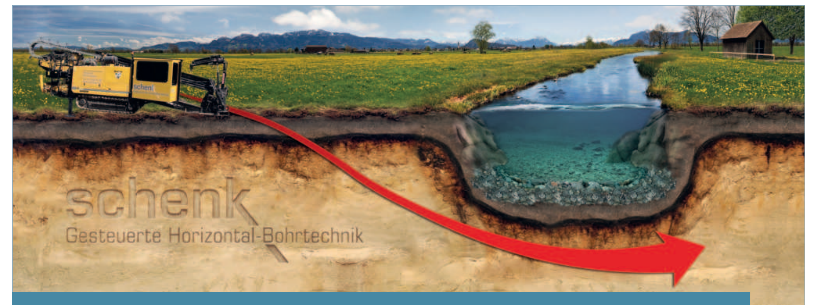
Abb. 3: Prinzip der Horizontalspülbohrung. Quelle: www.schenkag.com.
